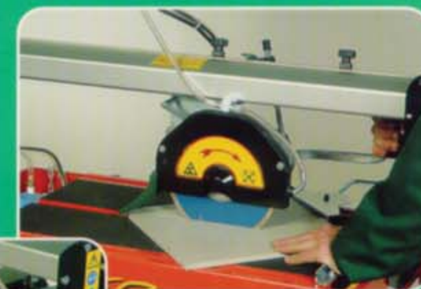
Regolazione progressiva dell'altezza di taglio
